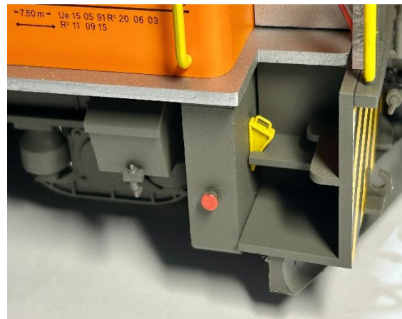
Bremsklotz Treppe hinten rechts + links
