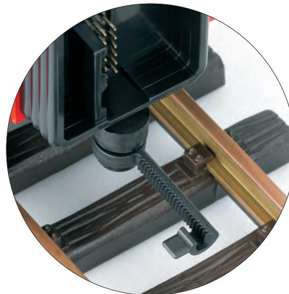
Ob kleine Innenanlage oder aber eine große Außenanlage, der LGB ALLEGRA kann überall eingesetzt werden. Dank einer neu entwickelten und bewährten, in der Länge verstellbaren Kurzkupplung sind beim Einsatz auf der heimischen LGB Anlage keine Grenzen gesetzt.
