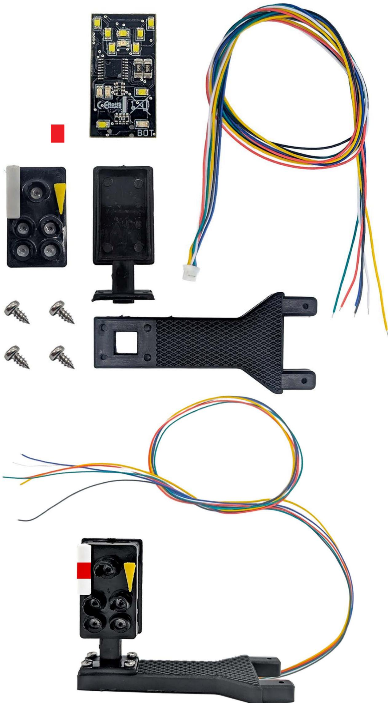
**Stecken Sie das LED Kabel hinten an die Platine.**
