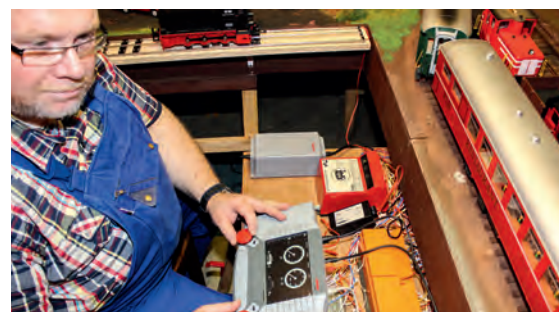
36 Digital aufrüsten: Holger Metschan ersetzt den Fahrtrafo durch CS2 und Netzteil und richtet eine Tablet-Steuerung ein.
