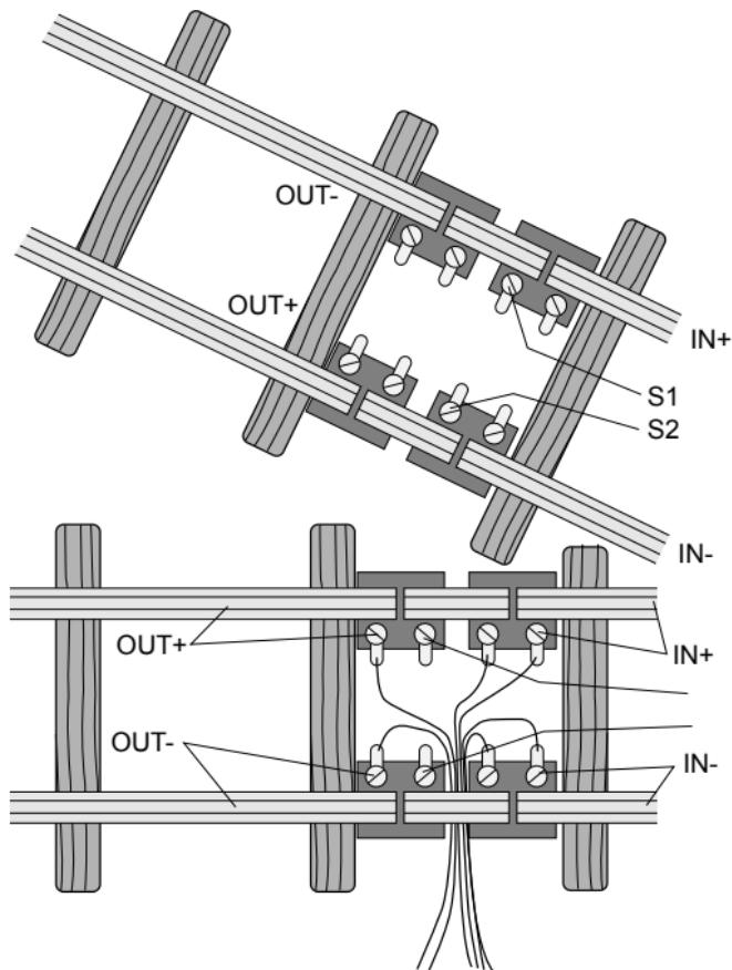
**Anschluss mit Dioden zur Verbesserung der Störsicherheit.**
